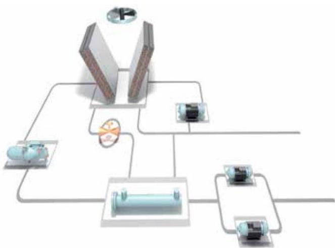
Естественное охлаждение — это эффективный способ снижения потребления электроэнергии при низких значениях температуры наружного воздуха. Оно повышает оптимизацию энергопотребления в ЦОД и охлаждение процесса.
