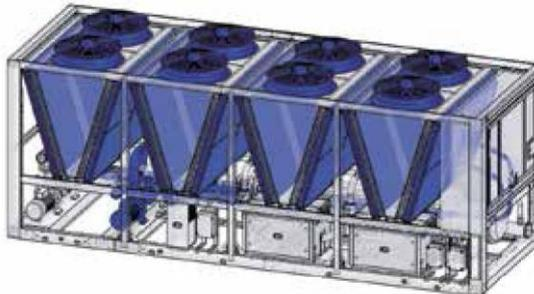
Чиллеры Uniflair интегрируют основные электрические и гидравлические компоненты на агрегатах. Контур естественного охлаждения, первичные насосы, ЧРП, водяные резервуары и автоматические переключатели могут устанавливаться на заводе, что сокращает этапы проектирования и монтажа и позволяет получить готовое к применению решение.
