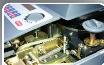
ВЫСОКОЧУВСТВИТЕЛЬНЫЙ МЕХАНИЗМ НАСТРОЙКИ ТОЛЩИНЫ И ДИАМЕТРА ОБРАБАТЫВАЕМЫХ МОНЕТ
