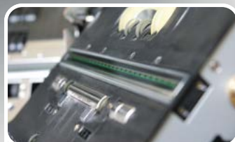
ПОЛНОЦЕННЫЙ ДАТЧИК ИК И ВИДИМОГО ОБРАЗА CIS
