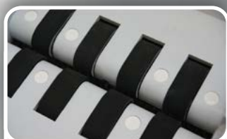
ПРОРЕЗИНЕННЫЕ РОЛИКИ для поочередной подачи листов
