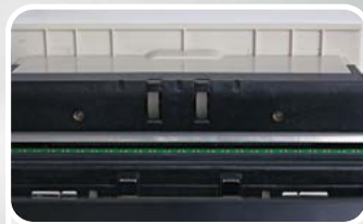
ОПТИМИЗИРОВАННАЯ ЛИНЕЙКА CIS ДЛЯ ВОЗМОЖНОСТИ ЧТЕНИЯ И РАСПОЗНАВАНИЯ СЕРИЙНЫХ НОМЕРОВ «НА ЛЕТУ»
