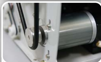
ДВУХФАЗНЫЙ ДВИГАТЕЛЬ ДЛЯ ВОЗМОЖНОСТИ ИЗМЕНЕНИЯ СКОРОСТИ СЧЕТА БАНКНОТ
