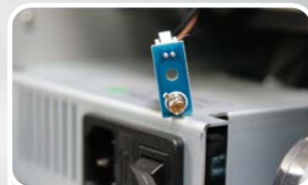
ВЫСОКОЧУВСТВИТЕЛЬНЫЕ ДАТЧИКИ СДВОЕННОСТИ
