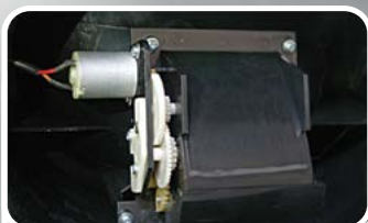
ОПТИМИЗИРОВАННАЯ СИСТЕМА ПОДАЧИ МОНЕТ НА СОРТИРОВОЧНЫЙ ДИСК
