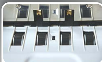
ЧЕТЫРЕ ПОДАЮЩИХ РОЛИКА ДЛЯ ОПТИМАЛЬНОГО СЛИСТЫВАНИЯ БАНКНОТ
